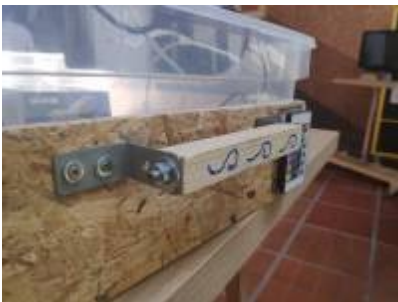
Étape 21 : Fixation du plexiglas sur le bac en bois et du tuyau avec son support imprimé en 3D
