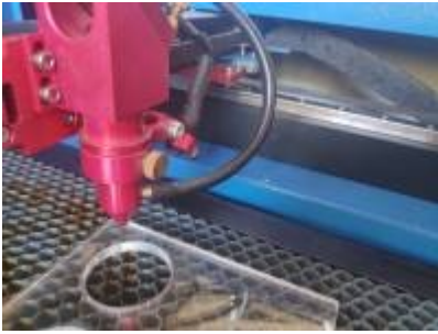
Étape 19 : Découpe laser du panneau en plexiglas servant de support au tuyau
