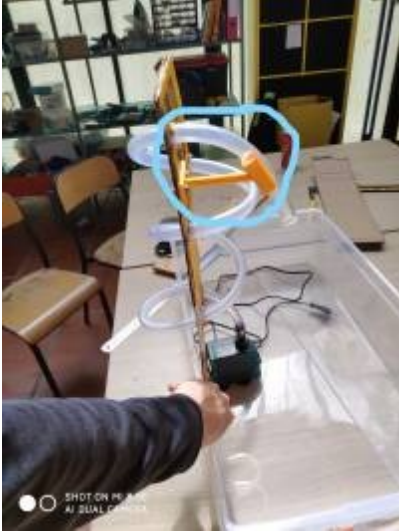
Étape 18 : Création d'un support imprimé en 3D pour la fin du tuyau
