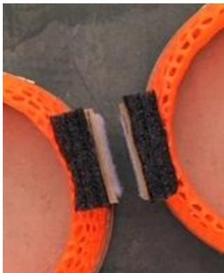
**Étape 5** : Une fois l'impression 3D terminer collé, avec l'époxy, le dôme sur le cercle platine final découpé précédemment avec la laser. Exercé une pression constant durant 24h sur l'ensemble des parties collées avec par exemple des livres.
